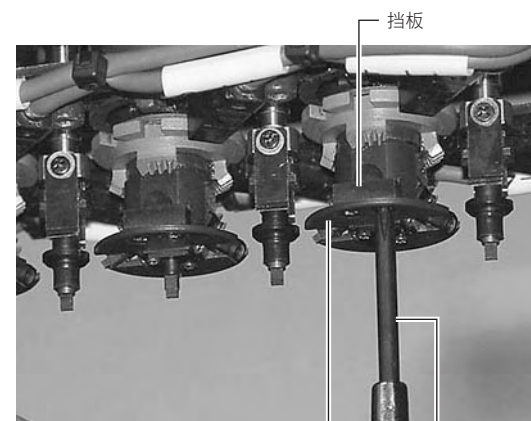
边提得多槽轴下沿 边拧松螺丝
